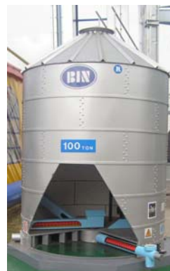
Ryc.23. Wnętrze silosu zbożowego – osłony przenośników podłogowych,
