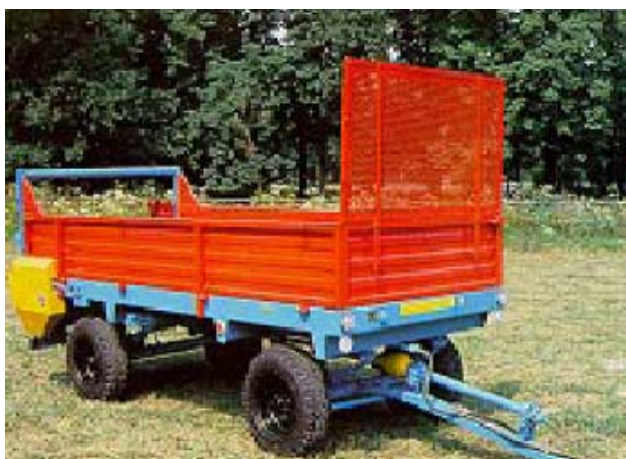
Ryc.91. Siatka zabezpieczająca operatora ciągnika [71]
