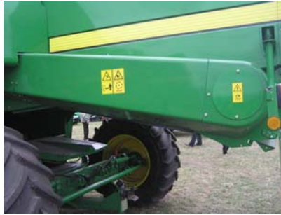
Ryc.100. Osłony napędu przenośnika kombajnu
