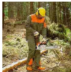
Ryc.138. Prawidłowe sposoby uruchamiania pilarki spalinowej [71]
