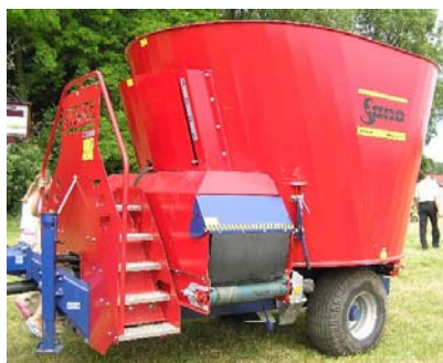
Ryc.24. Pomosty maszyn z barierkami ochronnymi
