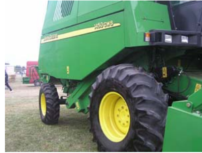
Ryc.101. Kompletna osłona elementów napędowych kombajnu
