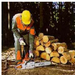
Ryc.138. Prawidłowe sposoby uruchamiania pilarki spalinowej [71]
