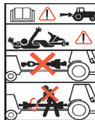
Ryc.70. Oznaczenia bezpieczeństwa na wałku przegubowym [61]
