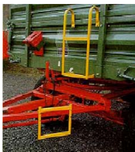
Ryc. 77. Drabinki i podesty do wchodzenia na przyczepę [71]
