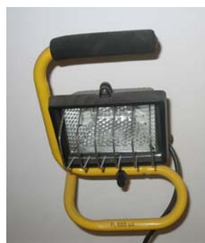
Ryc. 39. Właściwie zabezpieczona lampa przenośna – izolowany uchwyt, siatka. [Fot. E. Marciniak]
