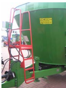
Ryc. 78. Poręcze i pomosty na maszynie [71]
