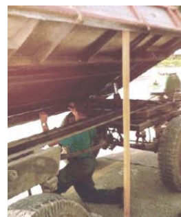
Ryc. 79. Zabezpieczenie skrzyni w czasie naprawy [71]
