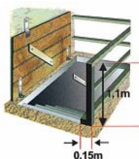
Ryc.26. Zabezpieczenie wjazdów stropowych [61].
