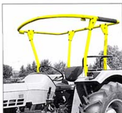
Ryc. 73. Ramy ochronne ciągników i ładowarek [35]
