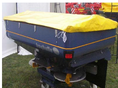
Ryc.89. Pokrowiec na skrzyni nawozowej
