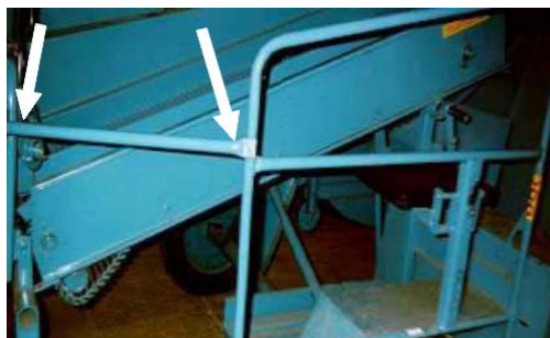
Ryc.102. Barierka ochronna na pomoście kombajnu ziemniaczanego [71]
