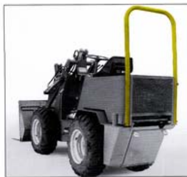
Ryc. 73. Ramy ochronne ciągników i ładowarek [35]
