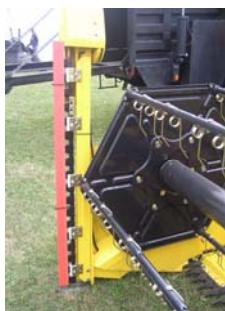
Ryc.95. Zabiezpieczenie listwy tnacej
