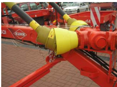
Ryc. 71. Osłony na wałku przegubowo- teleskopowym
