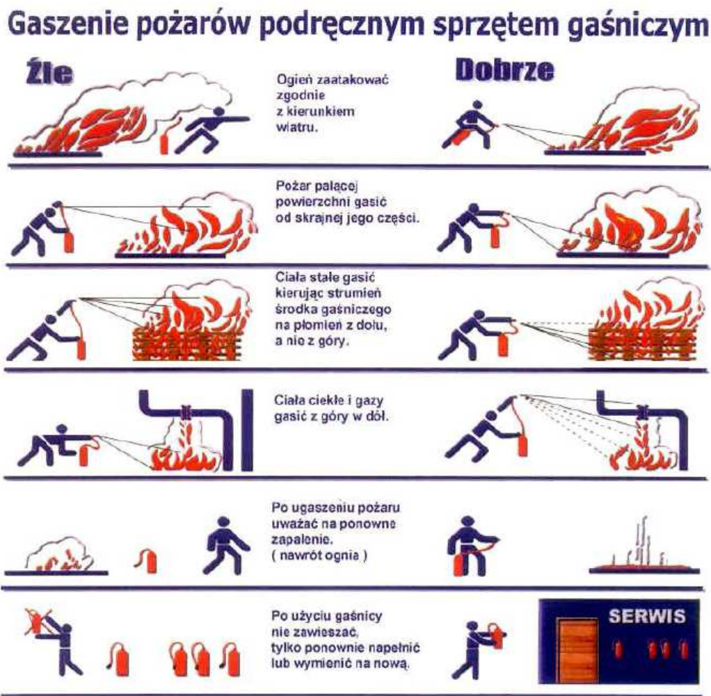
Rys. Nr 3. Ogólne zasady podczas gaszenia pożaru podręcznym sprzętem gaśniczym.
